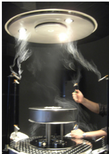
Abb. 3: Start der Prüfung durch Anzünden der Rauchmittel
